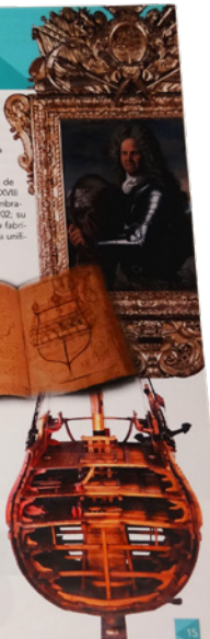
Sección transversal del galión Nra Sra. de la Concepción y la Armas. Construcción basada en los diseños del manual de Arte de fabricar Real de Gastañeta, fue uno de los últimos galiones construidos en España.
